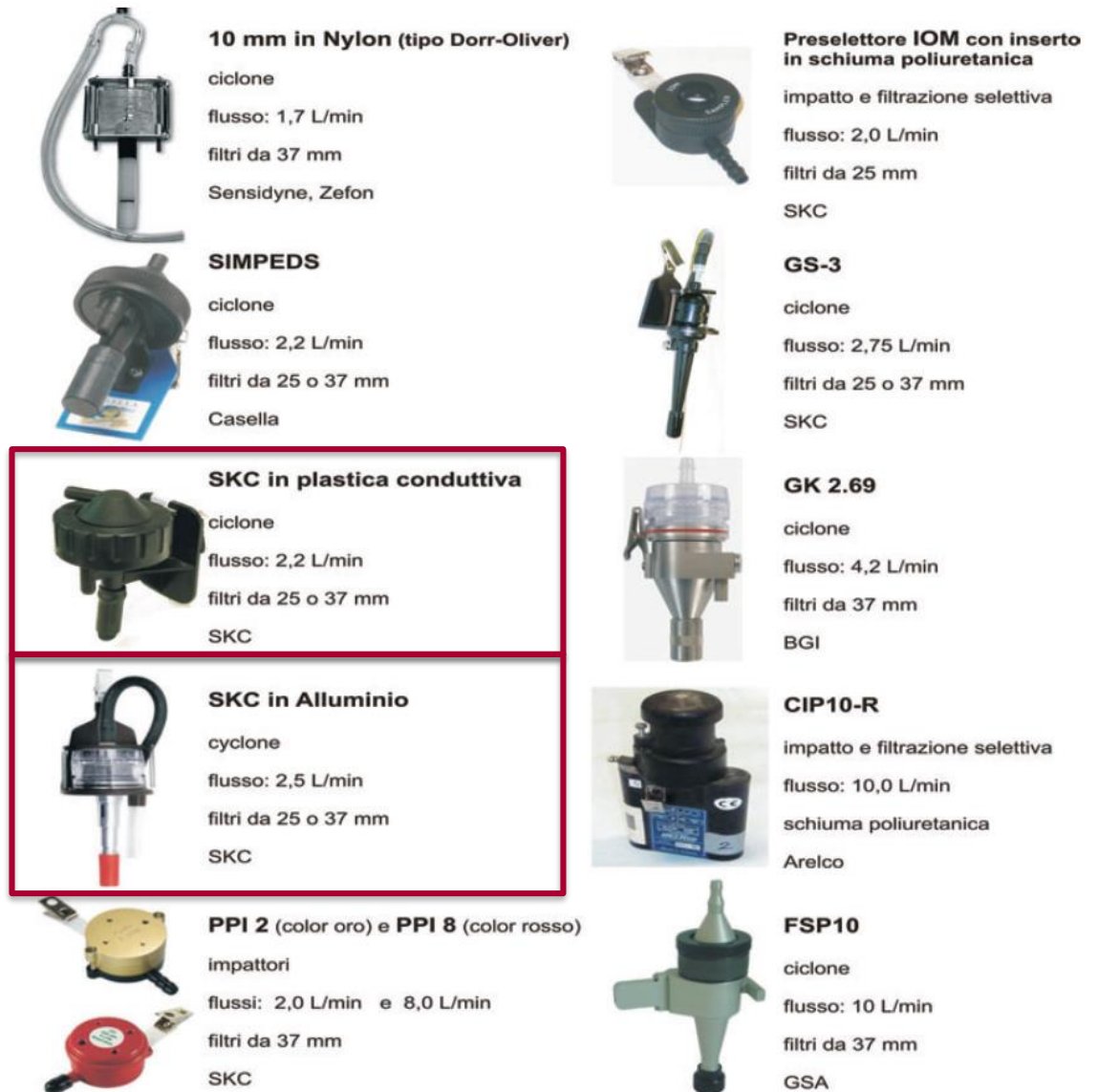
Figura 3.1. - Tipologia, flussi di aspirazione, substrati di raccolta del campione e produttori dei selettori personali per il campionamento delle polveri respirabili 16 .
